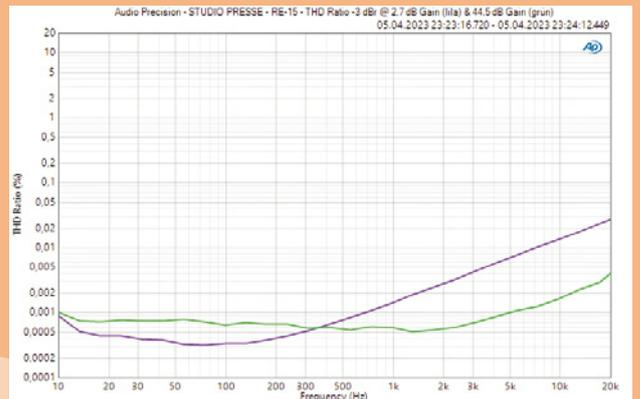
Diagramm 12: RE-15 – THD Ratio über die Frequenz, 3 dB unter Übersteuerungsgrenze bei zwei Verstärkungen, veränderte Skala links beachten!
